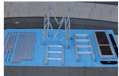
3段(5.3m)タワーの部材一式。
