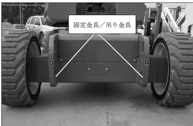
図9.4 - 後部の固定金具／吊り金具
