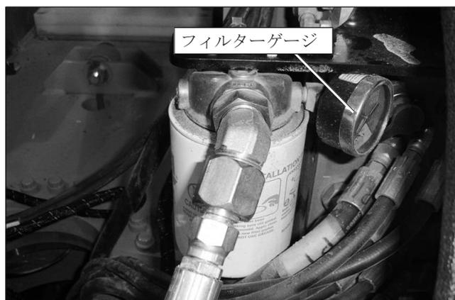
図 5.3 - 油圧作動油フィルターゲージ
