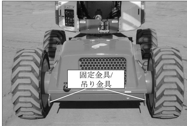
図 9.4 - 後部の固定金具/吊り金具
