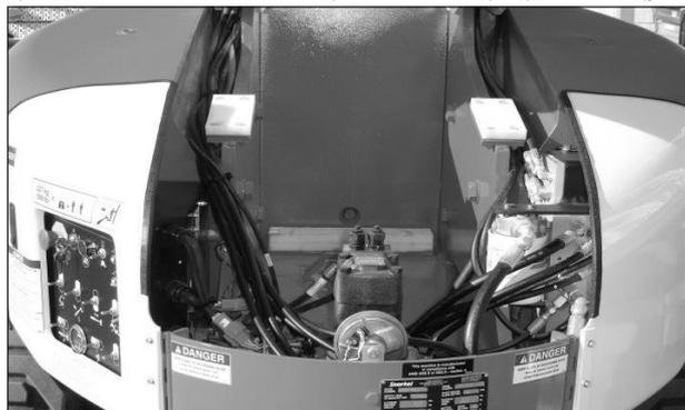
図 7.7 - ホース、チューブ、継手
