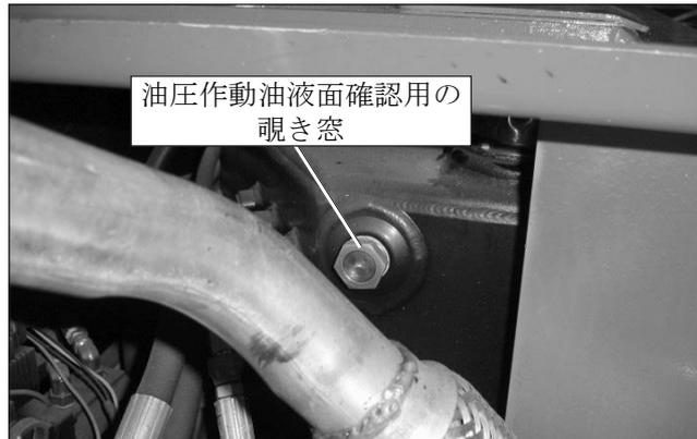
図 7.6 - 油圧作動油液面確認用の覗き窓
