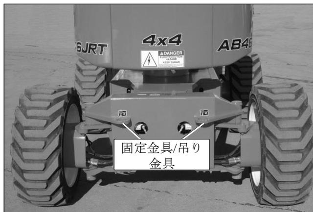
図 9.2 - 前部の固定金具/吊り金具
