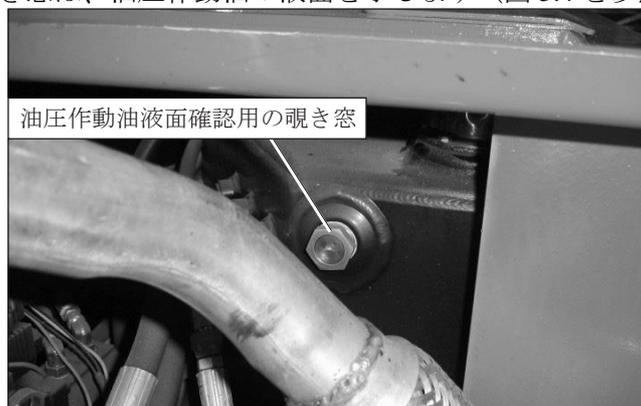
図 5.4 - 油圧作動油液面確認用の覗き窓
