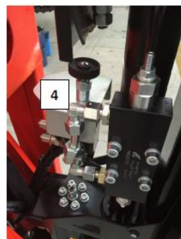
バスケット垂直シリンダーに位置するバルブ
