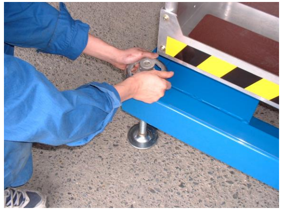
図4:機体前部ジャッキ
