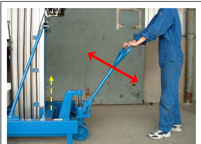
図 2: 機体のリフトアップ
