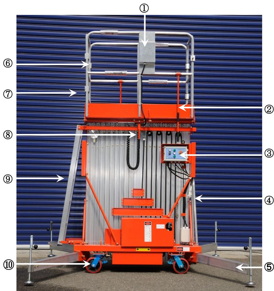
1 作業床操作盤（上部操作盤）
