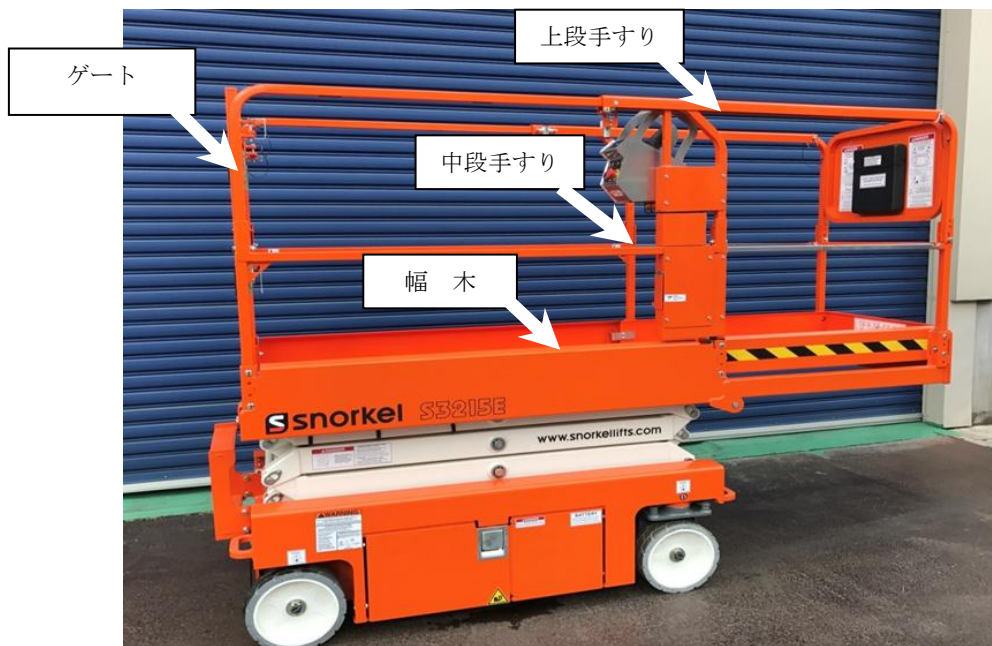
図 作業床周辺
