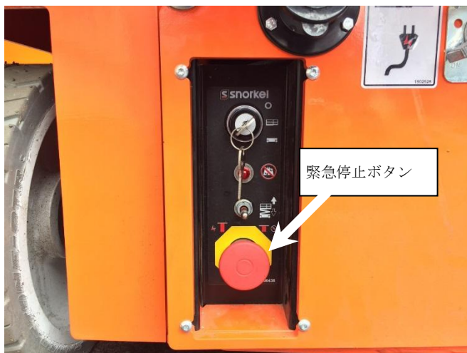
図 下部操作盤・緊急停止ボタン
