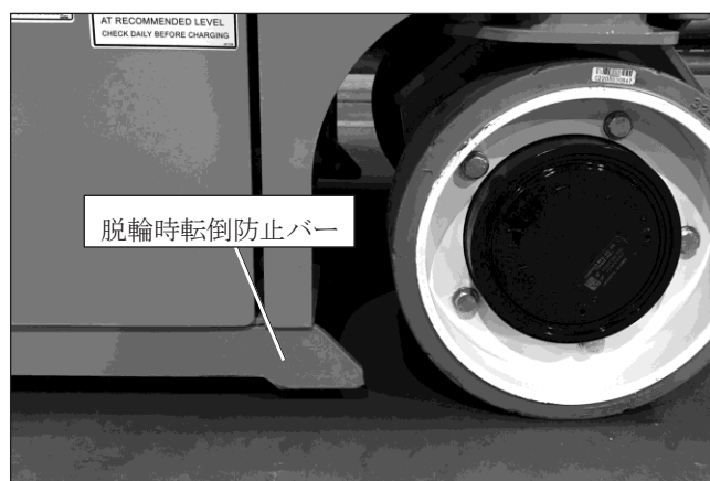
図8.9 – 脱輪時転倒防止装置（バーが降りた状態）
