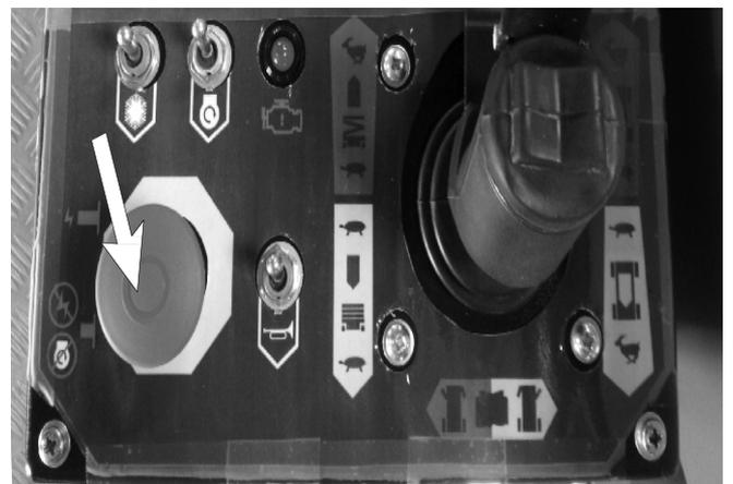
図 8.2 作業床側緊急停止スイッチ
