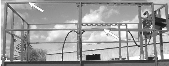
ゲートと組み合わさった中さんと幅木を含む手摺は、落下防止システムを形成します。これは作業者が落下する危険を防ぐことができます。すべての手すりが互いに正しく配置され、すべてのピンとボルトが適切に配置されていることを確認してください。手摺しっかりと固定され乗り込みゲートは閉じていることを確認してください。いずれかの部品が所定の位置にない場合、機能は不完全となり、作業員はリスクと危害分析を確認し、十分な落下保護方法を確保する方法を決定する必要があります。
