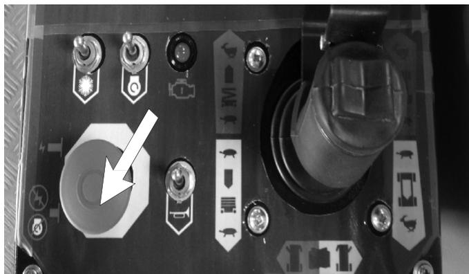
図 9.1 作業床側緊急停止スイッチ
