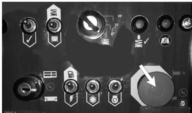
図 9.2 車体側緊急停止スイッチ
