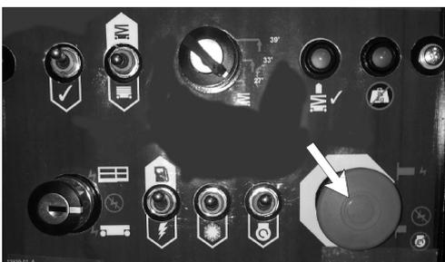
赤い緊急停止スイッチを押してください。どのような状況下でもエンジンは停止し、あらゆる機能がストップします。機械を運転する場合には必ずこのスイッチを上げて（ONに
