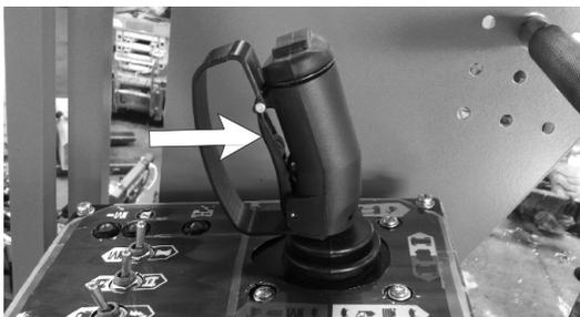
ジョイスティックで機械を操作する場合には、常にインターロックスイッチを握ったままにしなければなりません。インターロックスイッチは意図せずジョイスティックを倒して機械が動いてしまうことを防ぐ目的でついています。どのような方法でもインターロックを無効にしようとしないでください。
