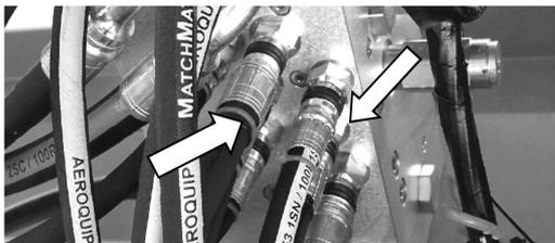
図 7.13 バルブマニホールドへの油圧ホース接続
