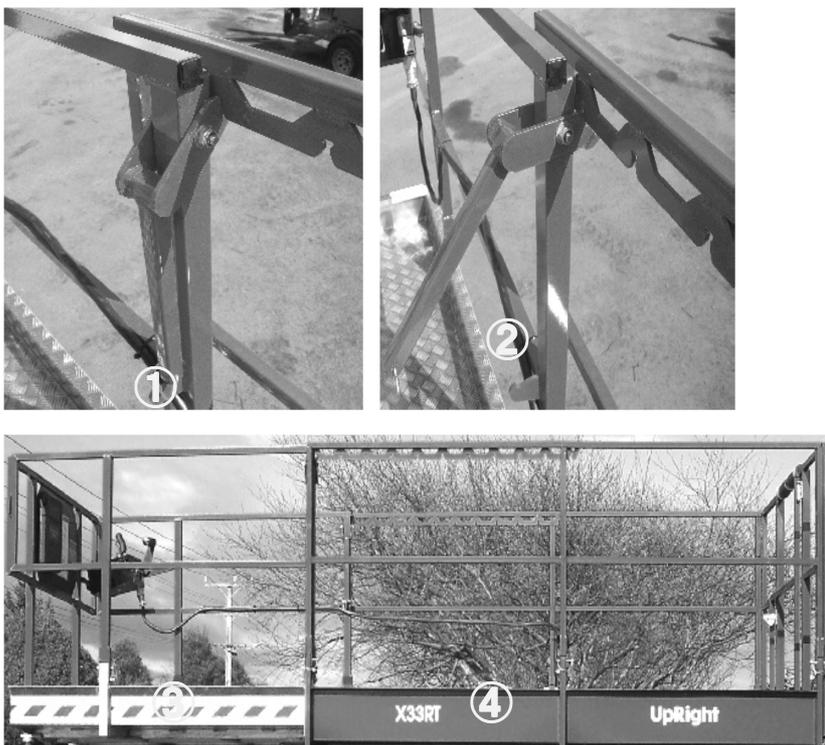
図 8.13 延長デッキハンドルロック状態①・延長デッキハンドルロック解除状態②・延長デッキ③・メインデッキ④
