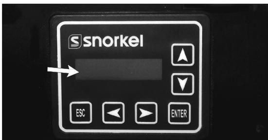
EzCal LCD ディスプレイはコントロールシステムの診断装置です。
