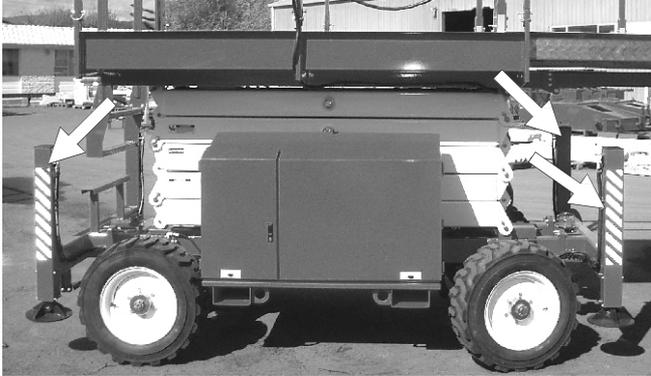
アウトリガーの操作は作業床側コントロールから可能です。アウトリガーは機械を水平状態にするためのものです。（操作方法の詳細は第 8 章・オペレーションの項を参照のこと）
