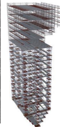
写真及びイラストは 800MW ボイラー (23.5mW×19.5mD×72mH) に 12 本のタワーを建てたものです。従来のスチールによる足場の組立と比較し施工時間は約 1/3 となります。
