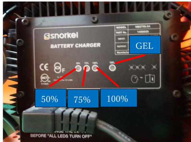
バッテリーとACケーブルをつなぎ、電源をつなぐと全てのLEDが2回点滅しその後、LED50%が点滅して充電が開始します。
