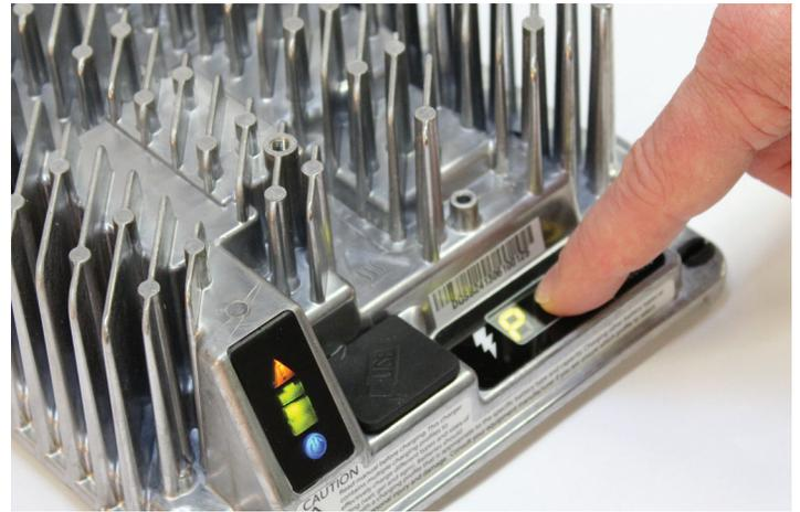
3. 「充電プロファイルの選択」ボタンを押してからリリースすると、充電プロファイルが切り替わります。選択した充電プロファイルは、最高3回表示されます（例：プロファイル11は「P-0-1-1」）。\*
