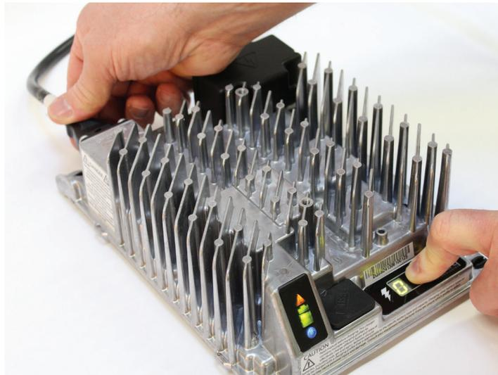
2. AC入力を再接続している間、「充電プロファイルの選択」ボタンを押します。エラーインジケータがオン（黄）になり、バッテリー充電インジケータ（緑）が点滅するまで、ライト確認機能でボタンを長押しします（約10秒）。
