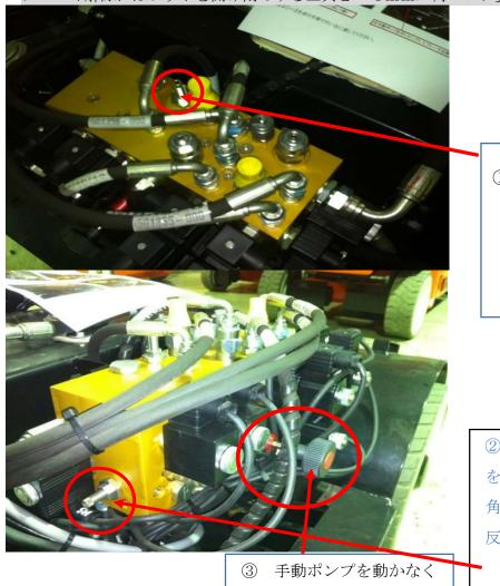
① ナットを緩め、先端に4mm六角レンチを当てて時 計回りにまわして閉じる
