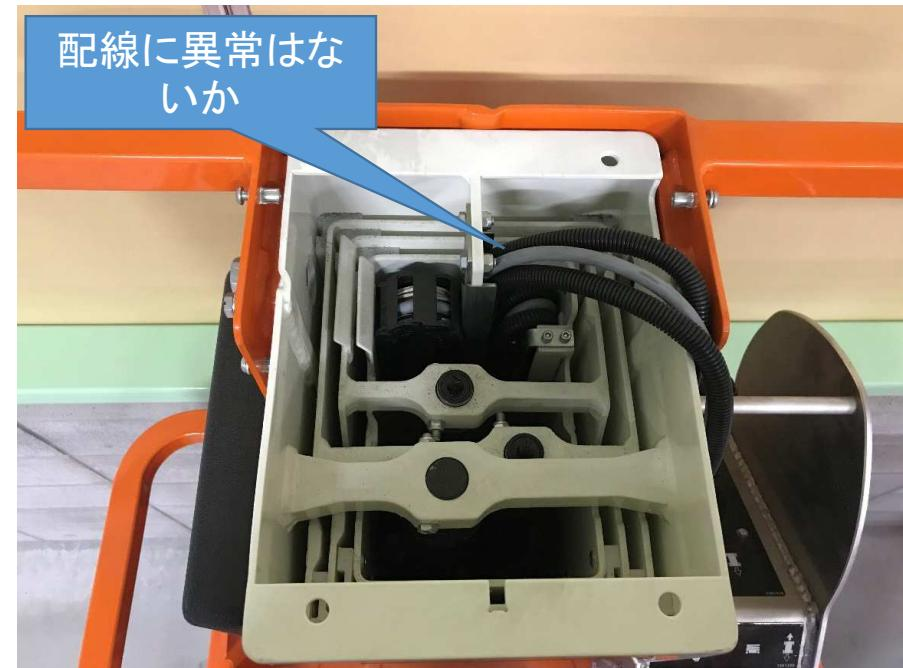
⚠ 作業床を上昇させて点検を行う場合、万一に備え安全支柱を使
