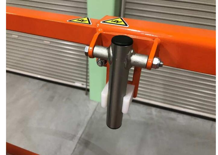
・作業床フレームに変形、溶接破損はないか。
