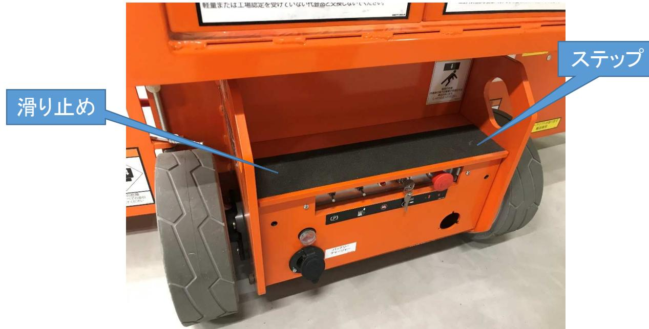
変形や損傷、滑り止めの破損はないか
