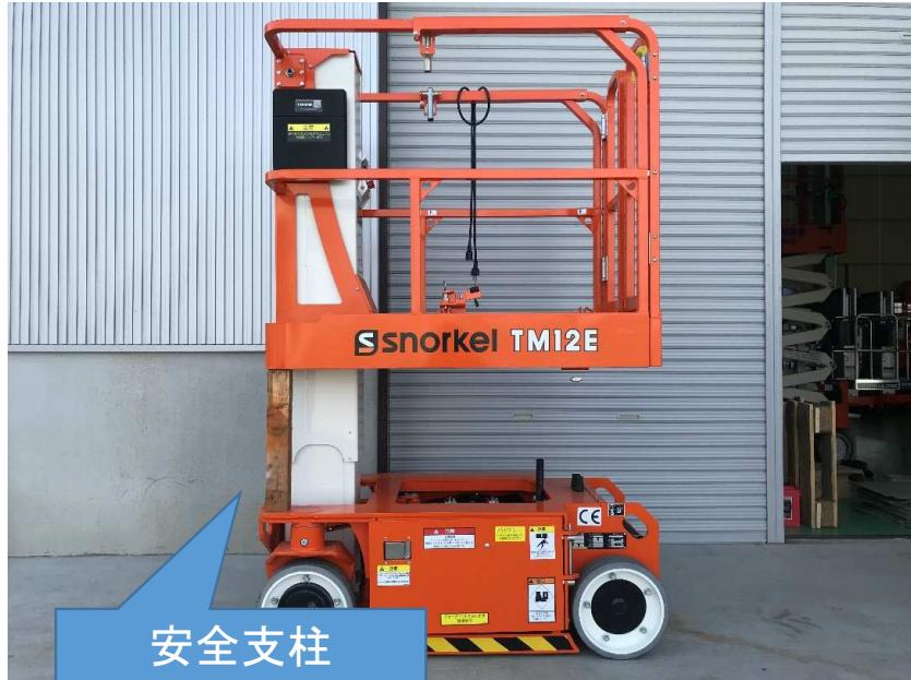
シャーシ天板の取り外しや、作業床直下からシャーシ内部へアクセスする場合は、必ず安全支柱を使用する
