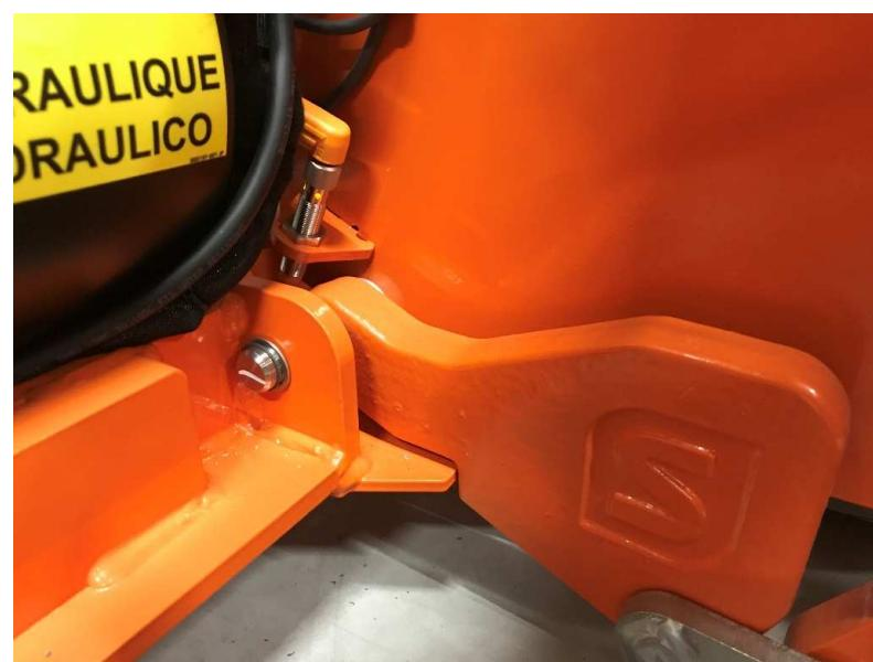
⚠️ 近接センサで格納状態を検出しています。マストとセンサの間に異物等が無い事を確認。
