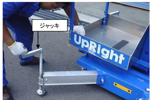
図 3: ジャッキを時計回りに回す。
