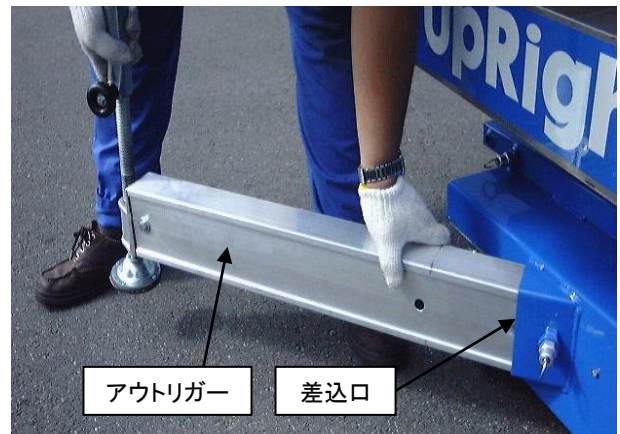
図 1: アウトリガーを差込む。
