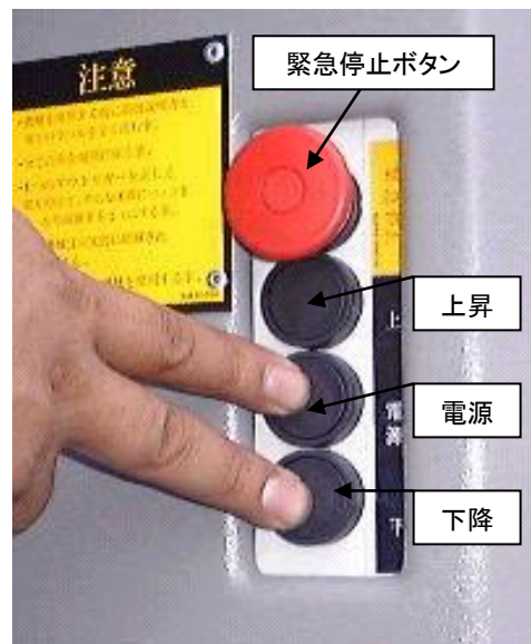
図 8: 操作ボタンボックス(バケット内)
