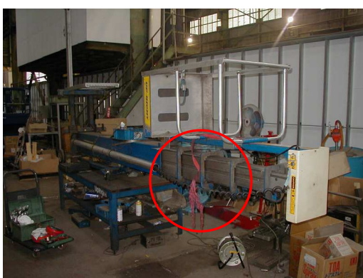
破断し垂れ下がったストラップベルト
