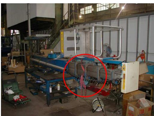
破断し垂れ下がったストラップベルト
