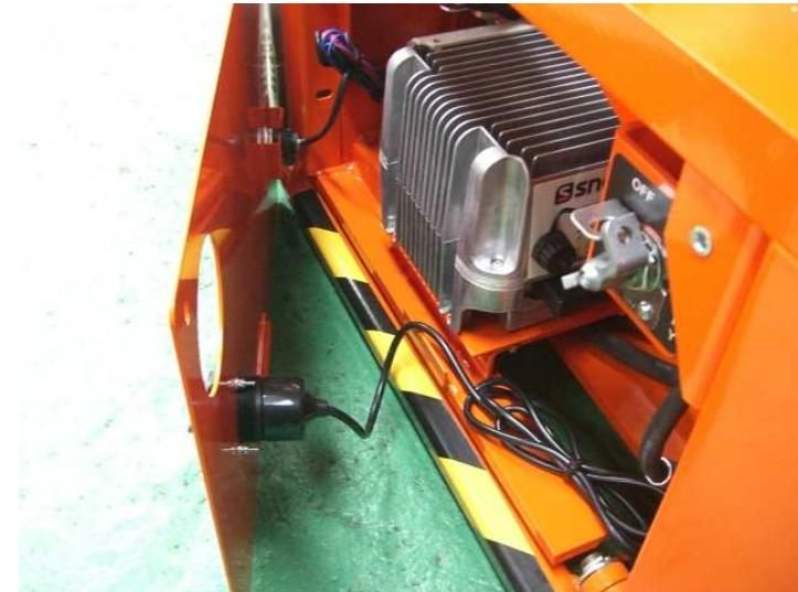
六角ボルト2か所を外し、パネルを取り外します。
