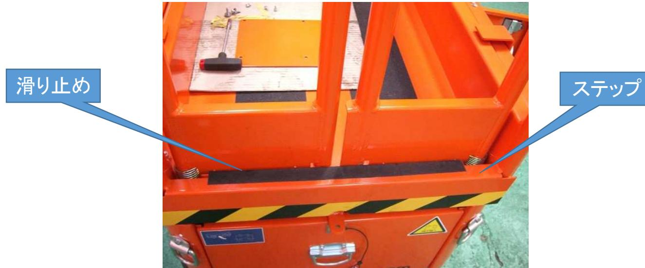
変形や損傷、滑り止めの破損はないか
