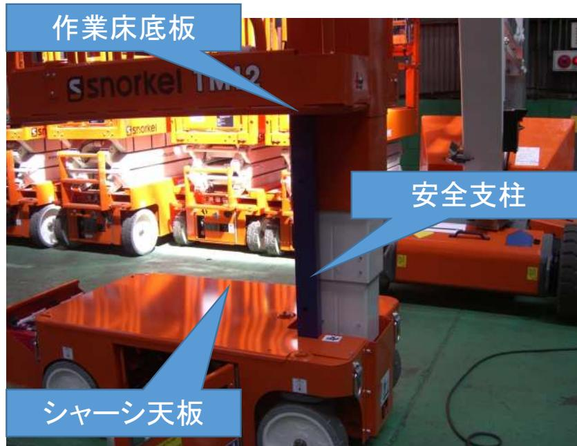
シャーシ天板の取り外しや、作業床直下からシャーシ内部へアクセスする場合は、必ず安全支柱を使用する
