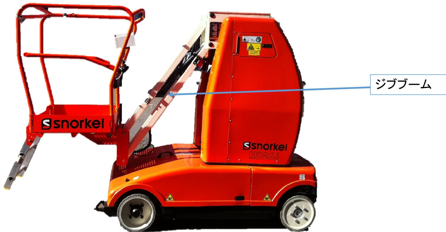
変形、溶接部亀裂/割れ、ピン摩耗、注油
