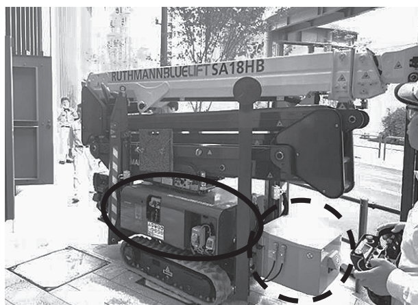
写真2 実機における動力源（型式SA18HB）
