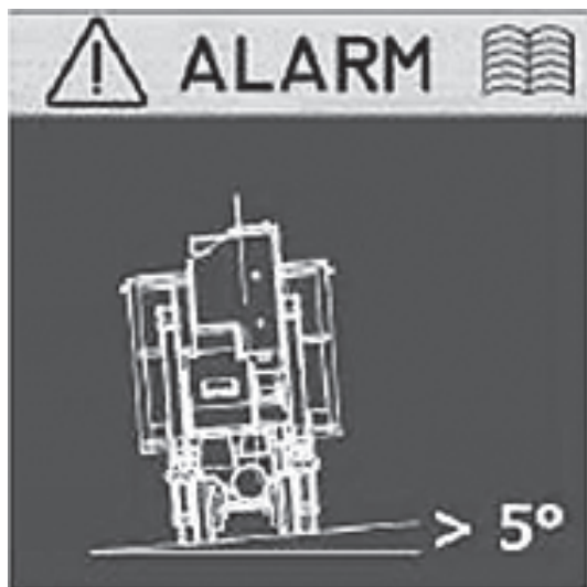
図4 傾斜角度検知機能（傾斜角度5°で走行停止）
